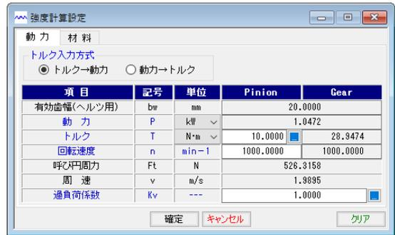
図 32.35 強度計算 (動力設定)
