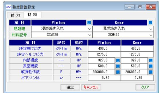
図 32.36 強度計算 (材料設定)
