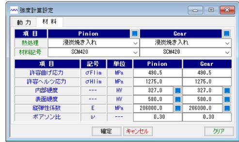
図 32.19 強度計算 (材料設定)
