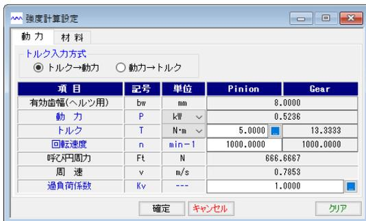
図 32.18 強度計算 (動力設定)
